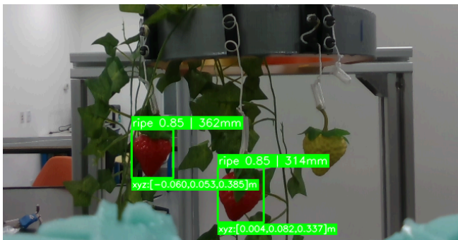
Figura 65. Paso 2, llamado a servicio de visión: Captura, detección y cálculo de PnP.
