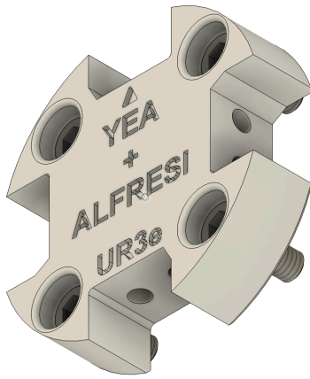
Figura 32. Vista isométrica rotada del acoplador compartido diseñado por YEA para el robot UR3e compartido, se muestran los tornillos M6 utilizados para anclar al robot.
