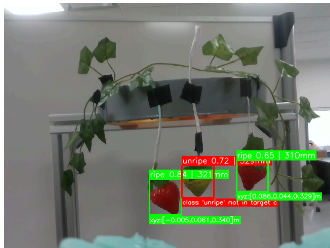
Figura 23. Prueba en condiciones de detección múltiple, mostrando que el modelo detecta ambas clases correctamente pero se filtra las “unripe” como no válida para cosechar.
