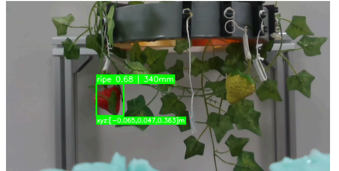
Figura 76. Paso 12, captura y detección para el segundo paso de validación.
