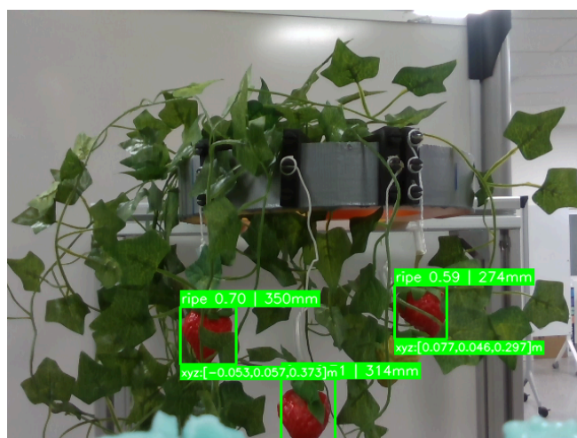
Figura 24. Prueba con obstrucción parcial en múltiples fresas, con diferentes niveles de obstrucción. Mostrando la eficacia del modelo en estas condiciones. De izquierda a derecha: >50%, <20%, ~30%.
