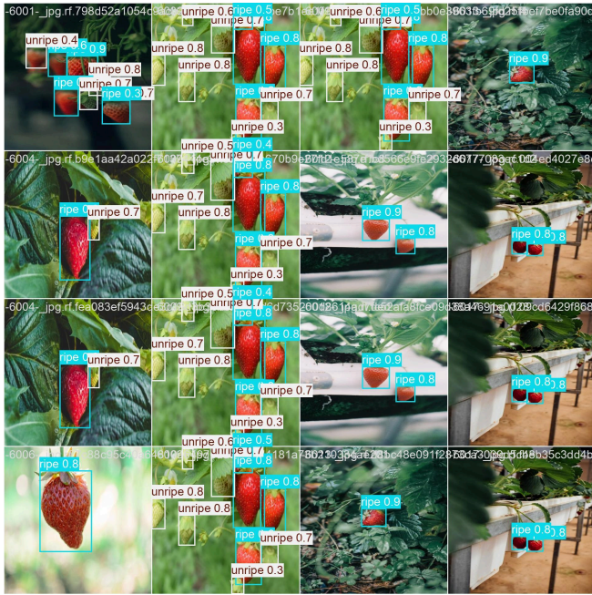
Figura 26. Matriz de imágenes de validación con el resultado de la inferencia. Se observa que el modelo detectó fresas que no estaban etiquetadas, generando una desviación en los resultados del proceso de validación.
