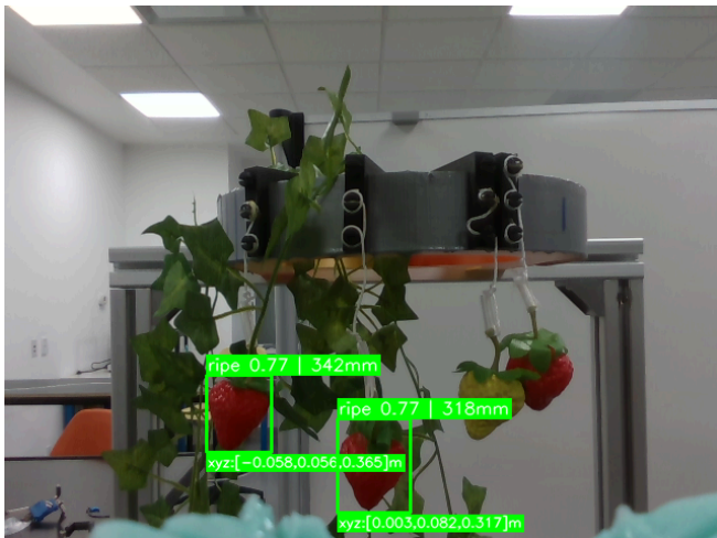
Figura 27. Falso positivo producido con un límite de confianza de 0.25 \pm 0.02 .
